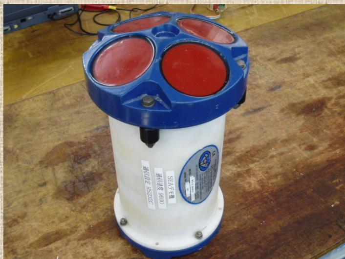
底曳網漁船が上を曳いてもひっくり返ることがない新しい流速計設置台(左図)を用いて、2002年6月から1年間流れの観測を実施しました。この設置台の中には、ADCPと呼ばれる超音波式の流速計(右図)が組み込まれています。
